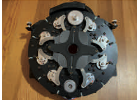
Profile-Modul mit Blendschieber-einheit und Iris-Blende
