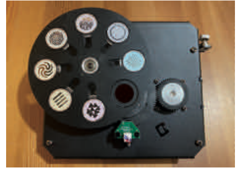
Spot-Modul mit zweitem Gobo-Rad und einer Iris-Blende
