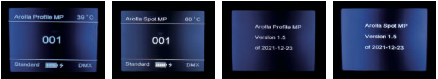
■ Spot oder Profile? Das Display zeigt an, welches der beiden Module automatisch erkannt wurde
