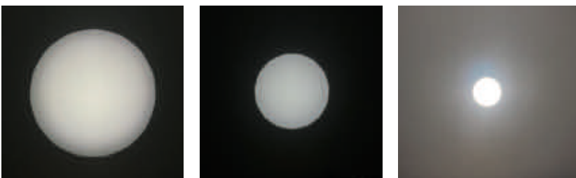
Iris-Blende mit 16 Lamellen sorgt für einen Abstrahlwinkel von bis zu sechs Grad
